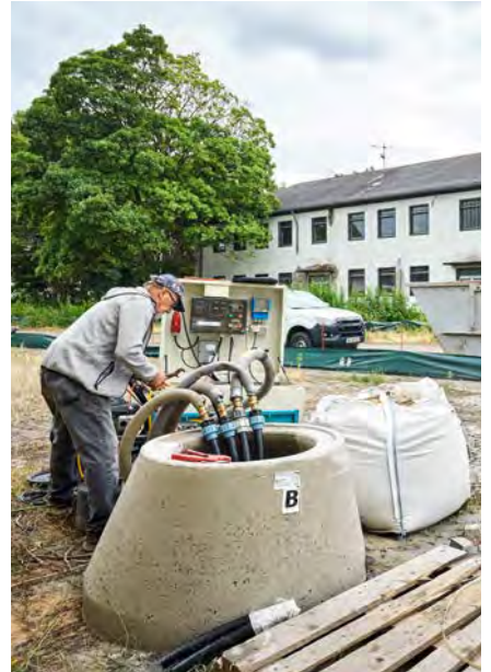
Der Geologe Jürgen Kahl beim Thermal-Response-Test. Mit ihm werden die Leitfähigkeit und erwartbare Wärmeentzugsleistungen bestimmt.
